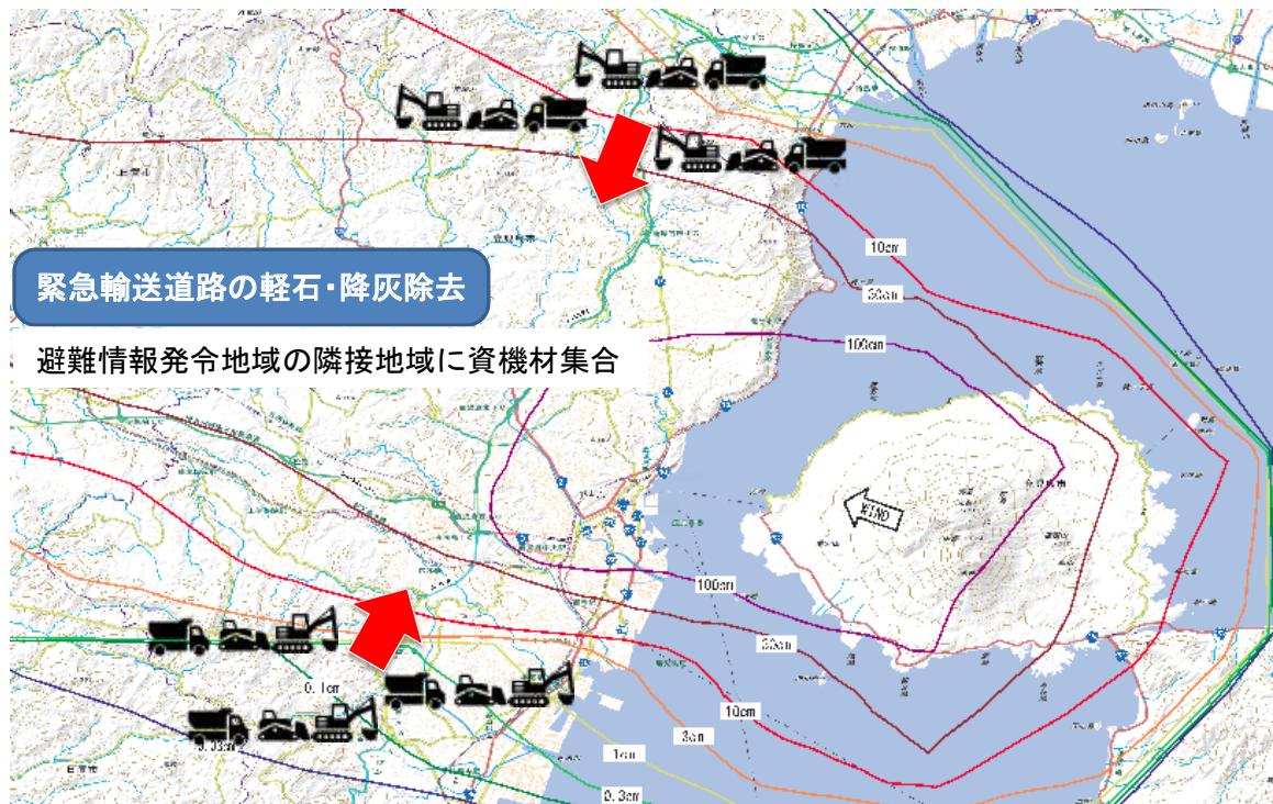
図 避難情報発令地域の隣接地域に設置した拠点からの除去開始イメージ
