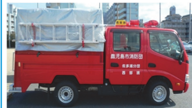
小型動力ポンプ積載車
