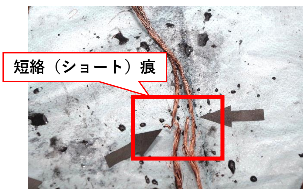
【短絡（ショート）したコードの拡大図】
