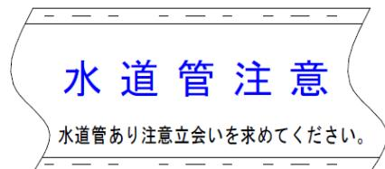
図3-73 明示シート布設の仕様例
