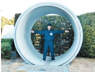
【南部幹線の汚水管】 鉄筋コンクリート製で、地下約10mの深さに埋設されています。内径2.4mで、本市最大の汚水管です。
