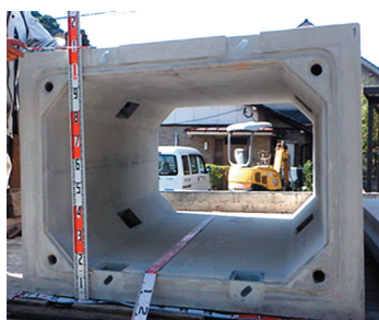
【雨水管きよ】 鉄筋コンクリート製で、縦横の長さが1m程度から3mを超えるものまであり、道路の下などに埋設されています。
