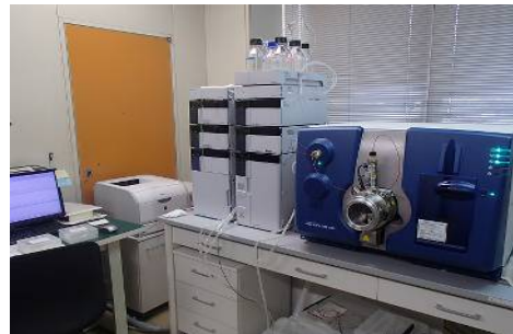
液体クロマトグラフ質量分析装置 (消毒副生成物等の分析)
