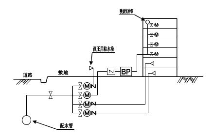
※直結直圧式と併用給水する場合は、直結直圧式給水階数は3階までとする。
