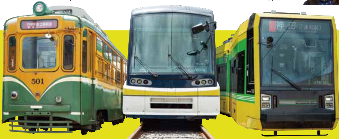
写真左より、局の最古参1955年製造の「500形」、接続式の運び屋・超低床電車「7000形」、最新モデルのルーキー「7500形」。
