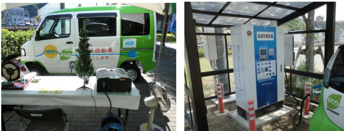
図 4-9 電気自動車から電気を取り出す外部給電器の活用と急速充電設備の導入
