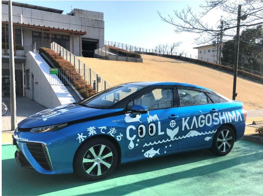
水素燃料から得られる電気エネルギーで電動モーターを駆動し走行する自動車。水素ステーションで水素燃料を充填します。
