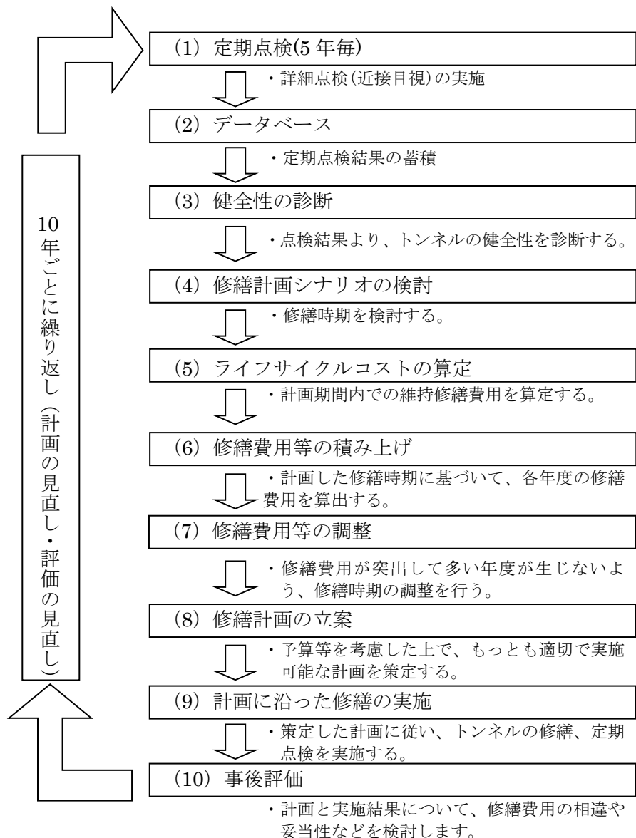
図 4.1.1 トンネル長寿命化修繕計画の流れ
