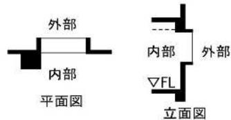
(柱又は梁型から出窓が突出している。)
