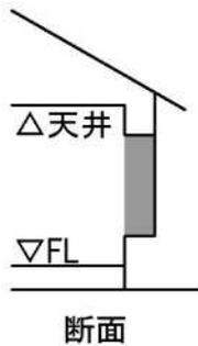
(3) マンションなどで出窓の上部が梁型に、又は側面が柱型に接している場合
