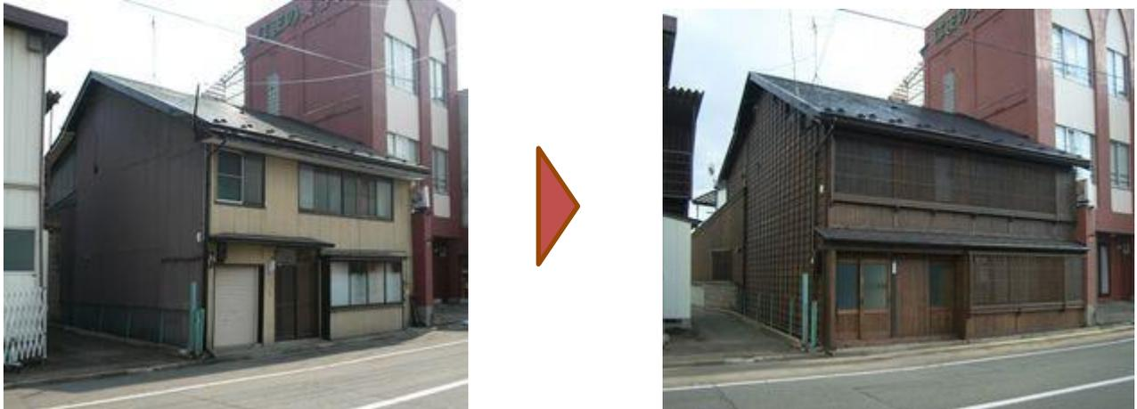
（明治期町家：400 年以上の歴史を持つ鍛冶屋。道路側は吹抜けの鍛冶場、2 階床、外壁は新建材で改造。）
