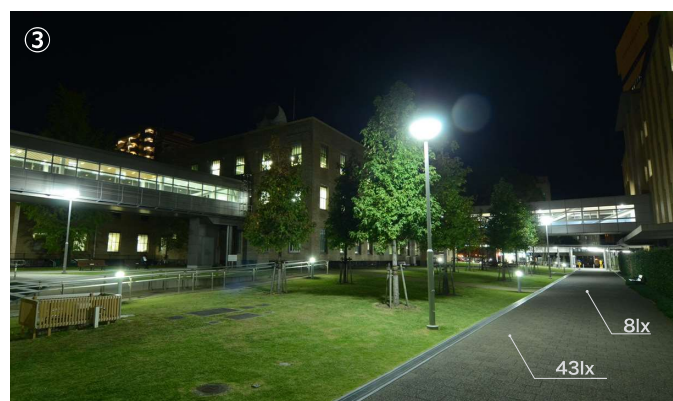
市道山下2号線の暗さに比べて、整備された中庭の明るさは抛り所のように感じられる。光源部分の輝度感を低減するために、もう少しまぶしさに配慮する必要がある。
