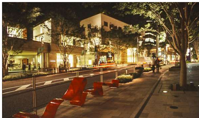
道路照明、建物や樹木のライトアップまで、色温度が統一されている街路。
