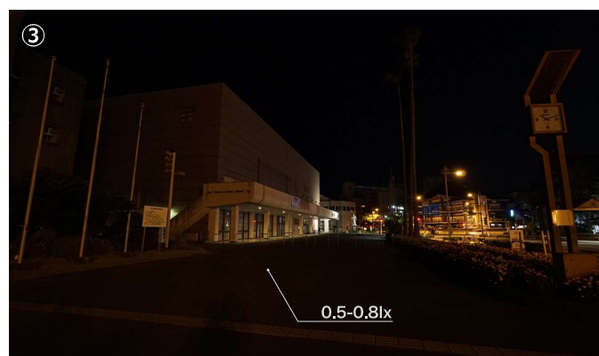
県文化センターのファサードには特にライトアップはされておらず、周囲の街路灯の光を少し受けていた。奥に行くほど光が届かなくなっている。
