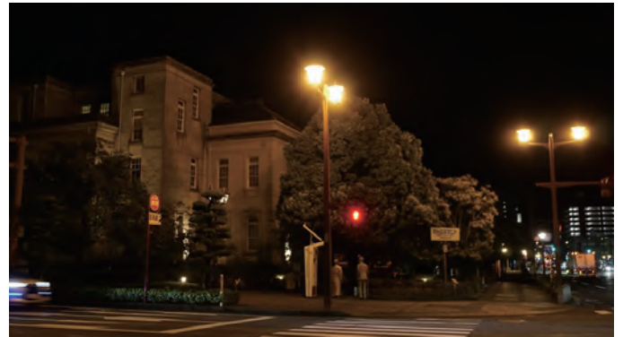
演色性の低いナトリウムランプの例。とくに樹木や植栽の緑が色あせて見える。
