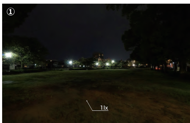
光源が直接見える街路灯がまぶしい。グレアによる周囲との対比が強く、広場の地面は実際の照度の値より暗く感じる。常緑樹の豊かな緑も、影となって壁のように感じられる。
