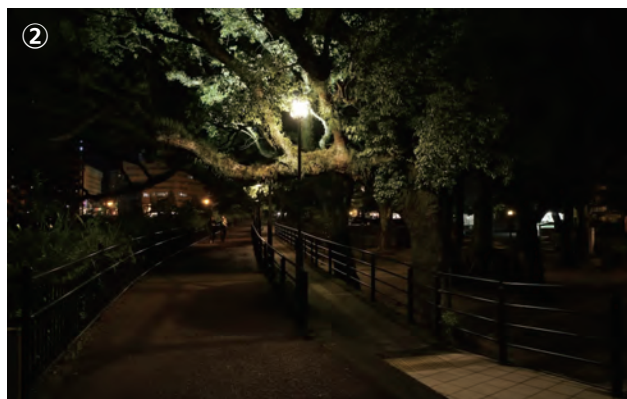
② ボールの上に、クスノキを広範に照らす投光器が設置されている。頭上の明るさ感を効果的に演出しており、離れたところからも樹木の緑を感じることができる。
