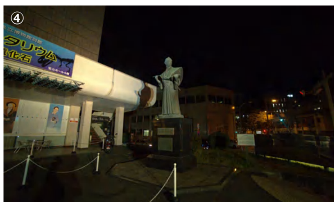
配光制御された灯具ではないために、対象の周辺一帯に光が届いている。結果として、銅像よりも建物の白い壁のほうが目立っており、何を照らしたいかの意図が明確ではない。
