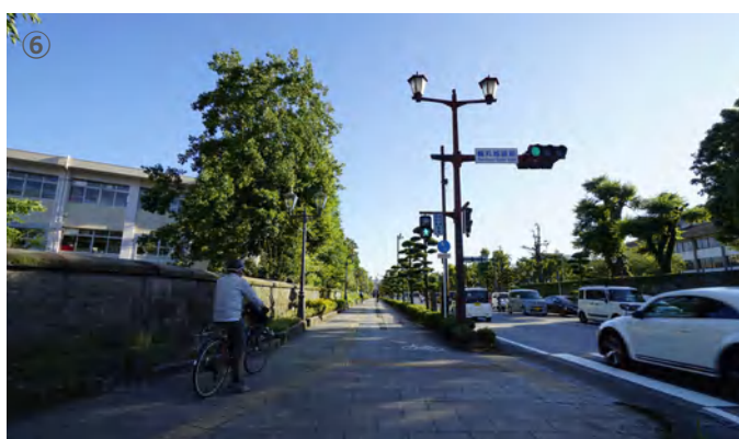
名山小学校横の交差点。車道の街路灯の光と、歩道のガス灯の光によって、路面の照度は必要十分に保たれている。
