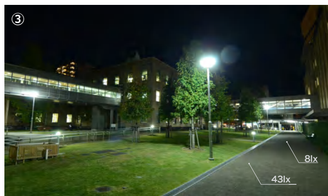
市道山下2号線の暗さに比べて、整備された中庭の明るさは抛り所のように感じられる。光源部分の輝度を低減するために、もう少しまぶしさに配慮する必要がある。
