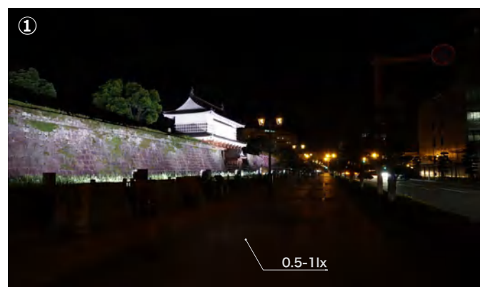
離れた位置から見たときにも目立つ明るさだが、少々パワーが強すぎて、石垣の凹凸や苔の表情が感じにくい。また、堀側の明るさとの対比で、手前に開ける歩行者の空間が暗く感じられる。
