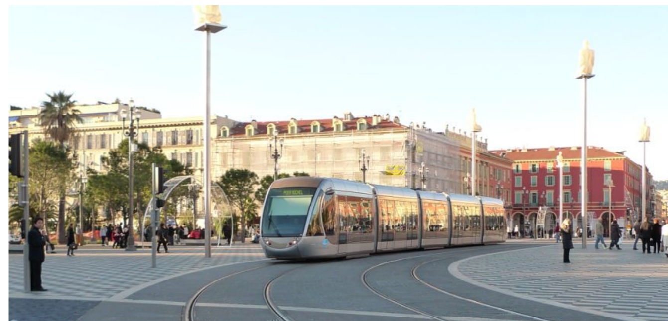
架線レス車両（バッテリートラム）：ニース（仏）
