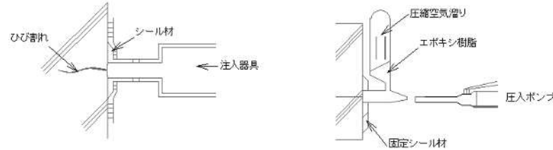
図-4 自動式低圧エポキシ樹脂注入工法
