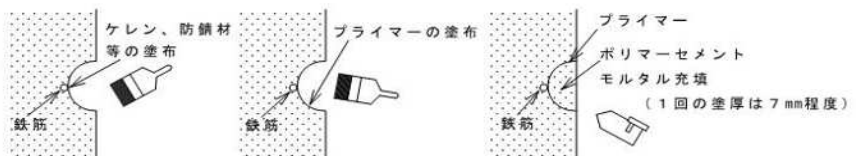
図-1 鉄筋露出の場合（ポリマーセメントモルタル充填工法）
