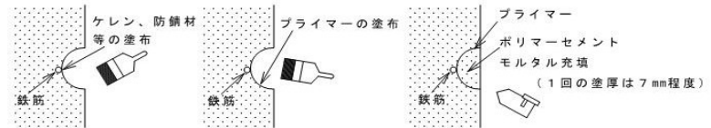
図一 鉄筋露出の場合 (ポリマーセメントモルタル充填工法)
