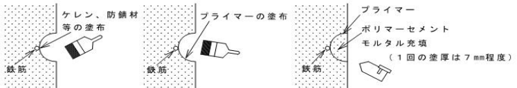
図一 鉄筋露出の場合 (ポリマーセメントモルタル充填工法)
