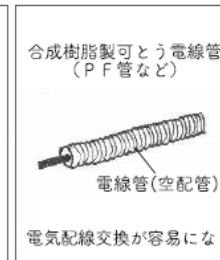
電気配線・配管
