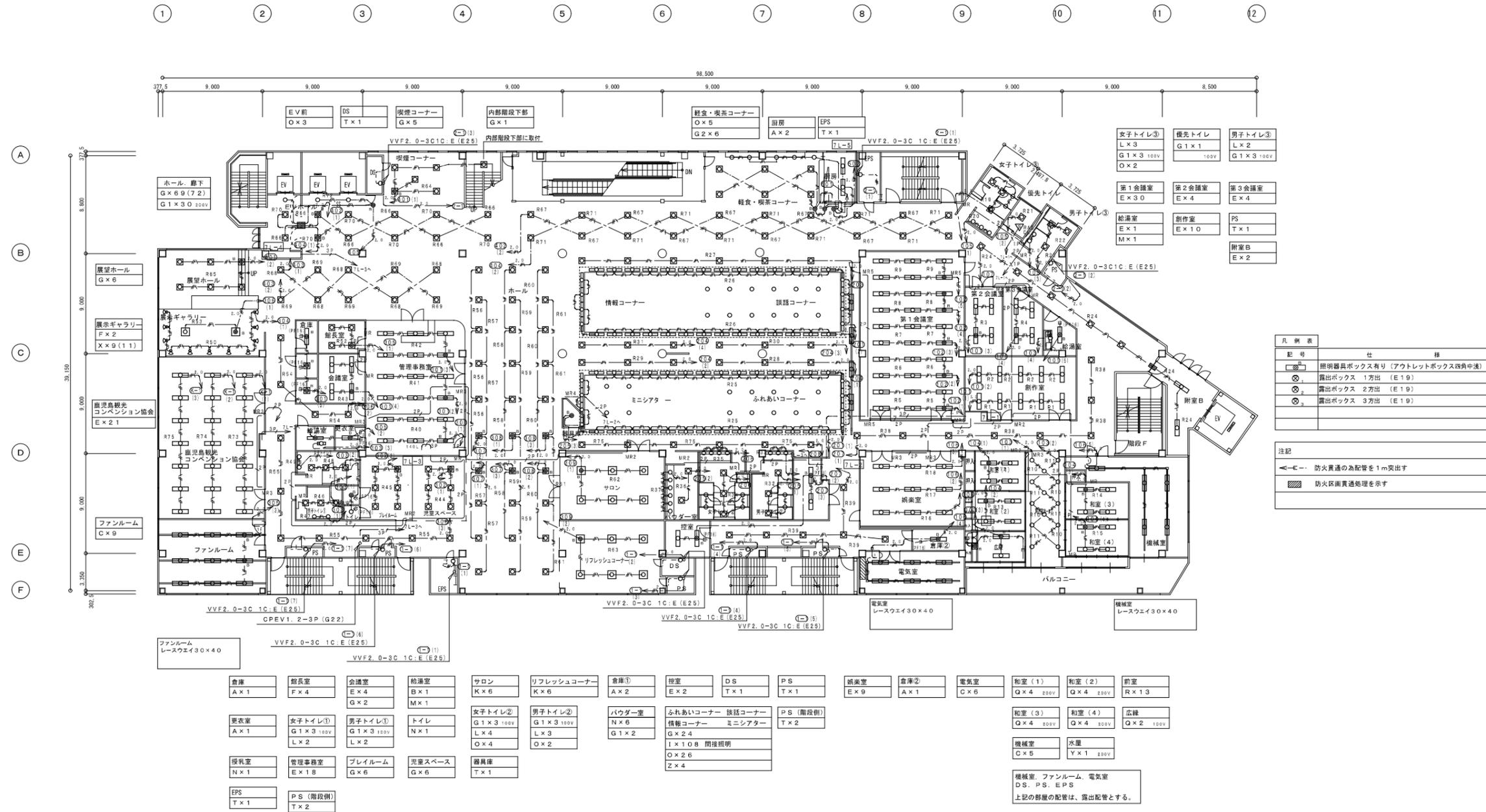
調光は既存を調査の上、照明制御用配線及び照明制御機器の改修を行う事。
