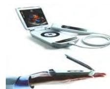
携帯型汎用超音波診断装置
