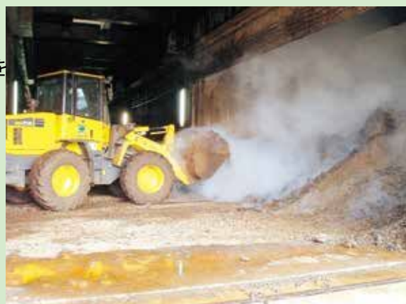
《脱水汚泥発酵中》
