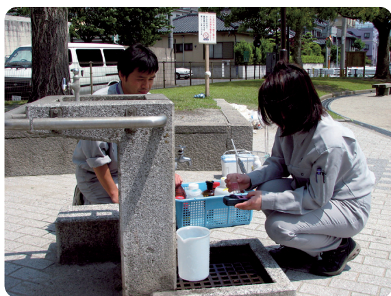
定期水質検査(管末給水地点採水箇所)
